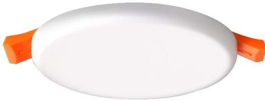
Le boîtier en aluminium moulé sous pression est doté d'un réflecteur en PMMA arrondi offrant un angle de rayonnement de 130°. Le boîtier est entièrement étanche, ce qui empêche les insectes d'y pénétrer, et est compatible pour les installations IP65 (ex : douches)
